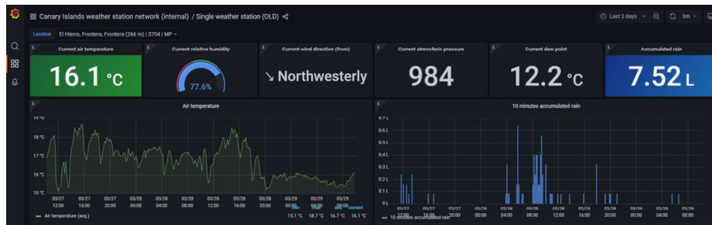
Figura 14. Ejemplo de los datos disponibles en tiempo real de la estación de Frontera en El Hierro. Además de estos, el sistema aporta datos sobre velocidad del viento y sobre radiación solar
