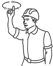
4 LEVANTAR EL AGUILON O PLUMA LENTAMENTE
