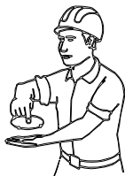
10 BAJAR EL AGUILON O PLUMA Y LEVANTAR LA CARGA
