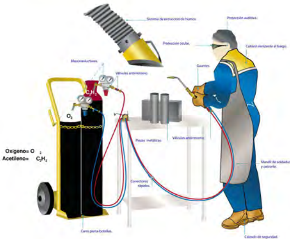
Estación correcta y segura para soldadura y oxicorte con soplete de gas.
